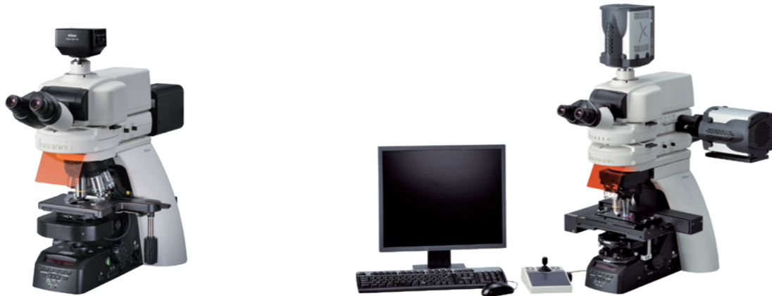
전동식 에피형광 조명 장치, 전동식 콘덴서 및 전동식 4 중 틸팅 튜브와 Digital Sight 100 카메라로 구성된 Ni-E(포커싱 스테이지)
