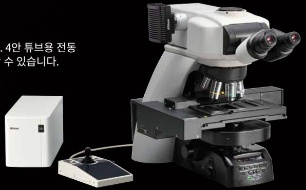
전동 4안 튜브용, 전동 DSC 줌 포트, 전동 ND 필터, 디지털 카메라 DS-FJ3, 전동 XY 스테이지 및 조이스틱, 제어 박스 A를 이용한 전동 현미경 Ni-E의 구성
