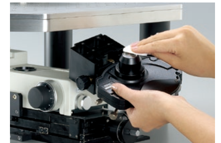
コンデンサーは取り外して水拭き可能
