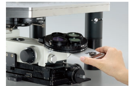
ポラライザー、ターレットも着脱可能で、交換が簡単
