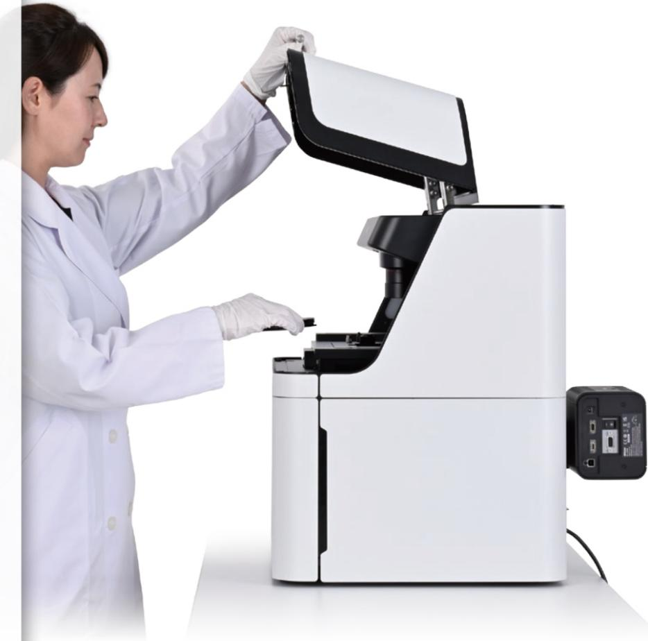
ECLIPSE Ji 适合标准实验室台面, 内置减震硬件, 可在明亮的环境中工作。无需专用空间或暗室, 即可进行高效的成像检测。
