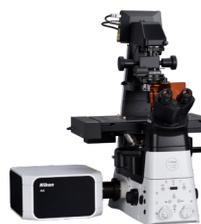
AX/AX Rは、従来機比4倍の8K x 8K画素の高解像度画像を実現。対角25 mmの広視野でサンプルの広範囲を一度に撮影でき、光毒性を低減します。AX Rのレゾナントスキャナーは、2K x 2Kの高解像度を実現。毎秒720フレーム(2048 x 16画素)の高速取得により、生きたサンプルの変化や反応を逃さず捉えます。
