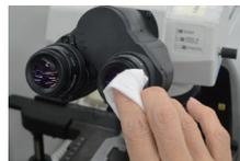
1 傷防止のため、ブロアーで埃を吹き飛ばします。その後、消毒剤を含ませたペーパーでレンズガラス面を拭きます。接眼目当てゴムは外して拭くと丁寧な消毒ができます。
