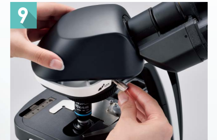
9 보관 중 튜브 방향 표시 튜브 잠금 나사를 풀면 튜브를 회전시켜 보관에 필요한 공간을 줄일 수 있습니다. 튜브는 떨어지지 않도록 설계되었습니다.
