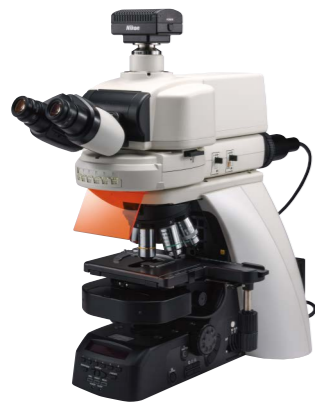
전동 에피 형광 조명 장치, 전동 집광기, 전동 4각 틸팅 튜브, DS-Fi3 카메라로 구성된 Ni-E(스테이지 포커싱)
