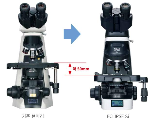
ECLIPSE Si 스테이지의 높이는 기존 현미경보다 약 50mm 낮은 135mm입니다. 하부 스테이지 디자인은 표본 슬라이드를 교체하는데 필요한 동작 범위를 줄여 팔과 어깨의 피로를 감소합니다. 스테이지 이동 노브의 위치도 더 낮기 때문에, 테이블에 손을 얹은 상태에서 표본 슬라이드의 다른 영역을 쉽게 탐색할 수 있습니다. 표본 홀더를 열고 닫는 레버도 작동하기 쉬운 크기의 모양으로 인체공학적으로 설계되었습니다. 또한, ECLIPSE Si는 슬라이드 교체를 최적화하기 위해 기존 현미경에 비해 스테이지가 30% 더 작습니다.
