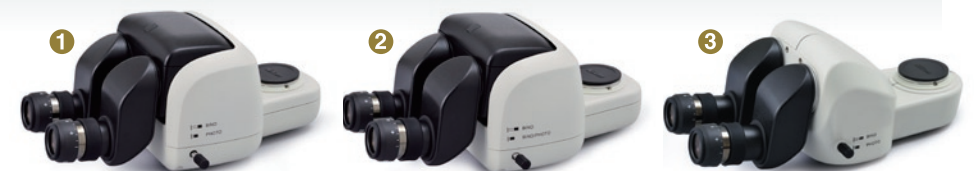
① 傾角三眼鏡筒 P2-TERG100(光路切替比100:0/0:100) ② 傾角三眼鏡筒 P2-TERG50(光路切替比100:0/50:50) ③ 低アイレベル三眼鏡筒 P2-TL100(光路切替比100:0/0:100)
