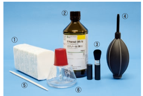
①レンズクリーニングペーパー ②無水エタノール ③クリーニングブラシ ④ブローア ⑤クリーニングスティック ⑥ハンドラップ
