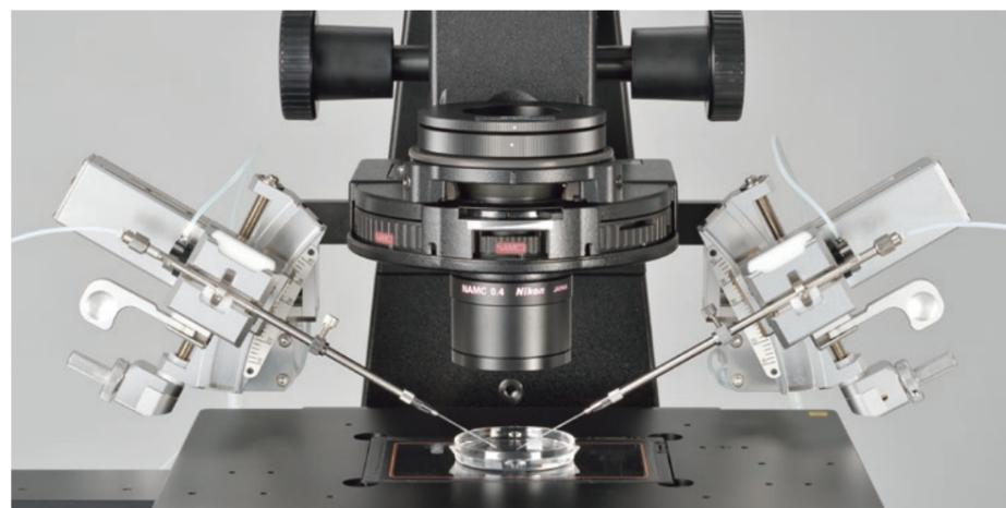
• ピペットの角度変更の際にも、ピペットの先端が視野内の同じ位置からずれません。
