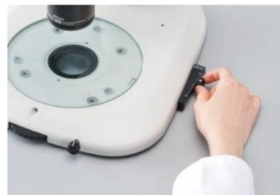
LED透過照明スタンドP-DSL32は、スライドレバーで、コントラストの調整ができます。
