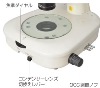
ファイバー透過照明スタンドP-DSF32は、OCC調整ノブでコントラストの調整ができます。
