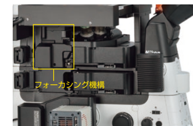
レボルバーに近接した剛性の高いZ駆動機構
