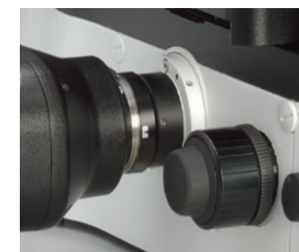
視野数25の大口径カメラポート
