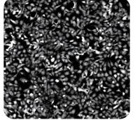
コントラストのほぼ無い透過光画像(位相差やDICではない)にVolume Contrast機能を適用することにより、物体の体積形状によるコントラストを形成できます。これにより、セグメンテーションなどの画像解析を行うことが可能になります。
