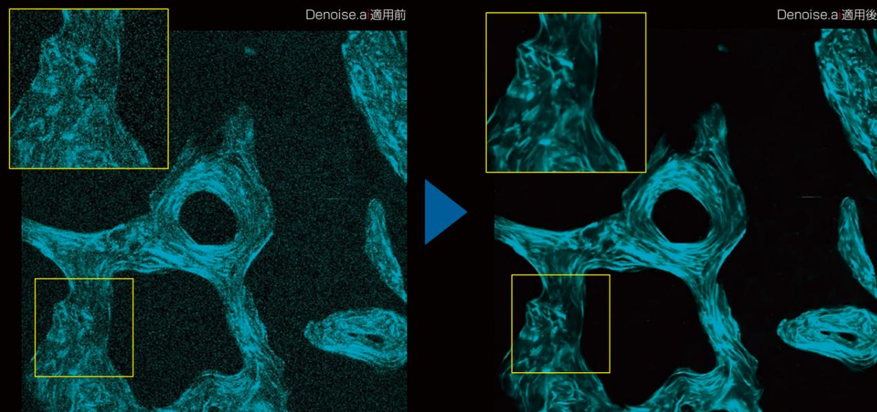
920nmのIR励起光を用いて、サル非脱灰骨切片のSHG画像を取得。
